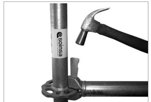
Un golpe con martillo en la cuña transforma la unión móvil en una insuperable unión fija. La roseta sin cajeado ni rebordes evita la posible obstrucción con hormigón, que podría dificultar el montaje.
