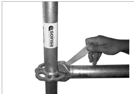
Inmediatamente se asegura el nudo mediante el simple giro de la cuña, esto significa que el montaje se puede realizar de forma segura por tan sola una persona, independientemente de la altura requerida.
